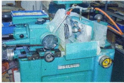
カーブゼネレーター(CG機)による球面研削。
