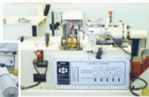
レンズの光軸を出し外径を定寸に加工。
