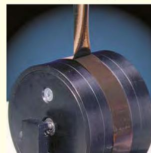
フレキシブルな基板の剥離強度
