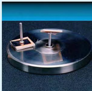
レジスト膜、めっき膜、DLC膜等の薄膜密着強度
