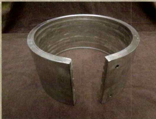
名称：ロールジャケットパネル サイズ：(R140)×153×17 水路サイズ：6×5 耐圧：2Mp(水)
