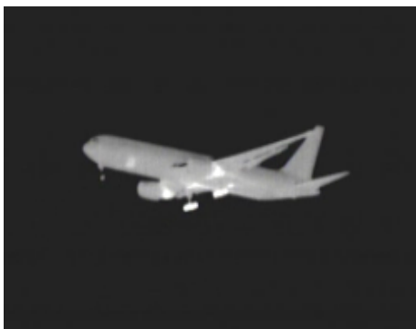
航空機（夜間 距離約1.5km） ・カメラ：VIM1024G2 ・レンズ：f=225mm
